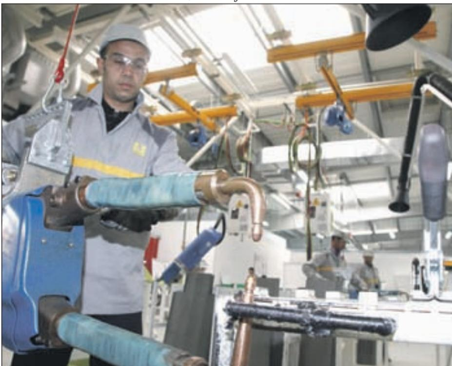
Le soudage est l'une des étapes les plus exigeantes de l'usine de Tanger. Elle requiert une dextérité maximale. Le soudage des pièces embouties se fait par points (Ph. Bziouat)
