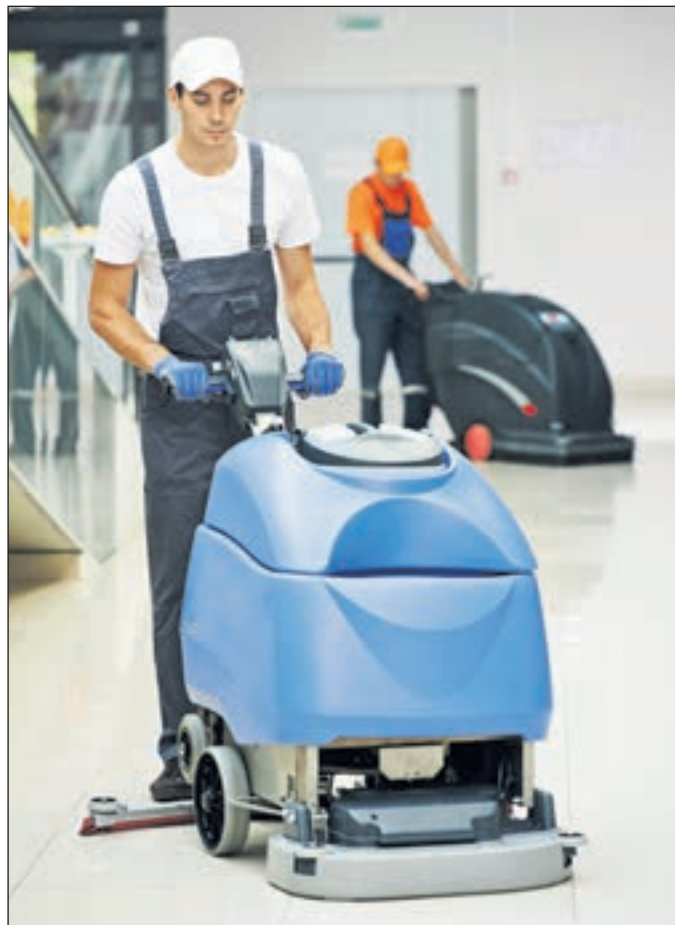
Parmi les équipements de dernière génération, l'autolaveuse. Une combinaison du principe de la monobrosse et de celui de l'aspirateur à eau (Conception Fotolia)
