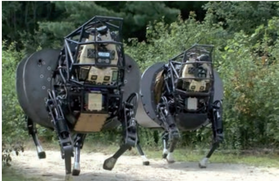
LS3, le robot de l'armée américaine, possède des caractéristiques très intéressantes. D'une extrême précision et bardé de capteurs, il obéit aux ordres vocaux de son leader, décide seul de la meilleure trajectoire et peut se relever pour se remettre en marche. Idéal pour les missions d'infiltrations ou de déminage. En plus il ne saigne pas !
